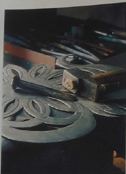
Scalpello e martello: due degli attrezzi prevalentemente usati per la lavorazione manuale, a freddo, del ferro (qui sopra).
